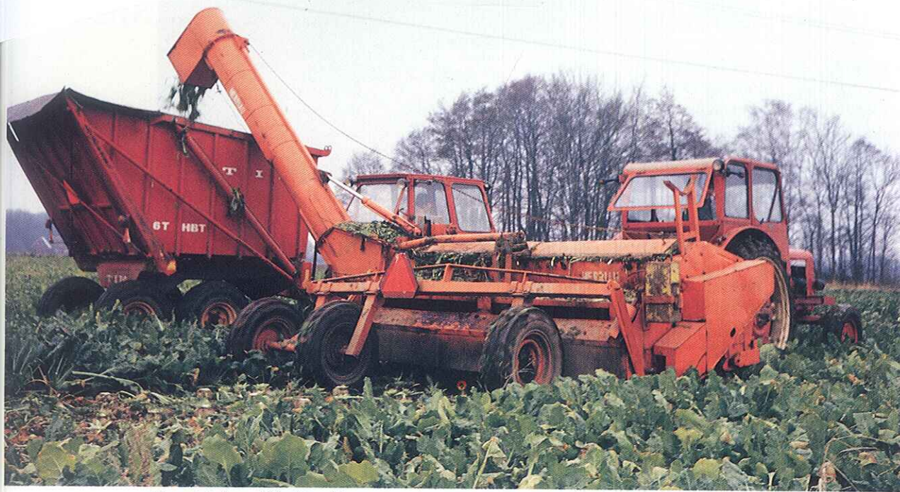
Blastskörd med Herriau-blastare.
